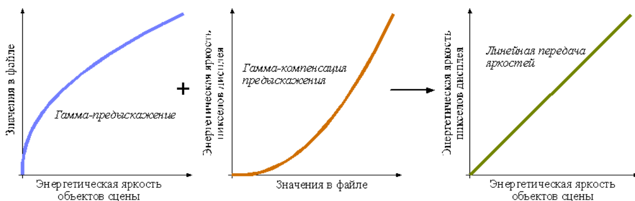
Рис. 19. Общая схема, иллюстрирующая процессы гамма-предыскажения и гамма-компенсации. Результатом является линейная передача яркостей объектов сцены пикселями дисплея.
