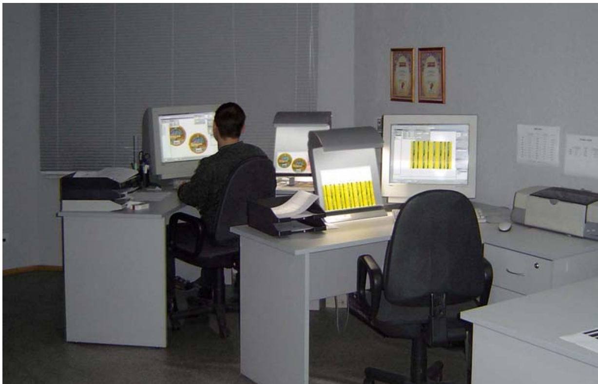
Рис. 23. Digital Darkroom в отделе препресс флексографского предприятия «Аляска-ПОФ» (Санкт-Петербург). Полную изоляцию от дневного освещения обеспечивает светонепроницаемый алюмоламинат, закрепленный на стеклопакетах за декоративными серыми жалюзи. Background-освещение: люминесцентные лампы Philips 950, просмотрные устройства: Just-Normlicht Color Master S.
