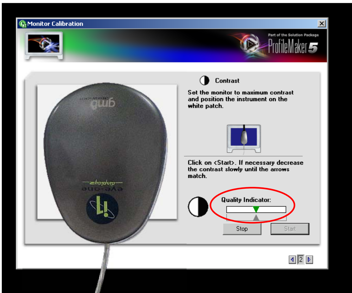
Рис. 50. Второй «шаг» процедуры калибровки. (Показано наиболее удобное позиционирование измерительного прибора i1 Display II при настройке мониторов с CRT-дисплеями.)
